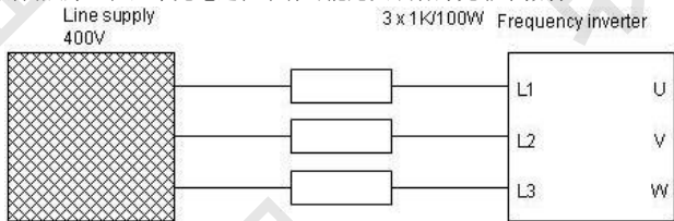
图 10-1 400V 驱动装置充电电路示例
