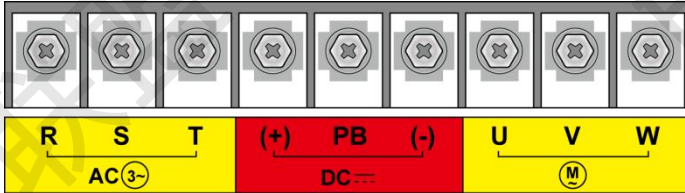
图 4-4 EC160A 电梯智能整体机主回路端子排的布局(18.5kW~30kW)
